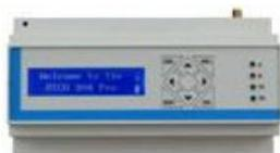
Figura 1 - RTCU DX4 Pro—Concentrador programável com interface GSM, RS485, RX232, entradas/saídas digitais e analógicas
